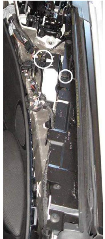
6. Lösen Sie den schwarzen Stecker mit dem weißen Bügel vom Steuergerät.
