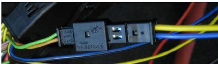
10. Stecken Sie die losen Pins vom Modul Kabelbaum in den Verdeck-Steuergerätestecker ein. Blau/schwarz auf Position 13 und gelb/schwarz auf Position 12. Verbinden Sie das Modul mit dem Modul Kabelbaum.
