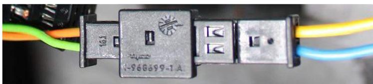
9. Stecken Sie die losen Pins vom Modul Kabelbaum in den Verdeck-Steuergerätestecker ein. Blau/schwarz auf Position 41 und gelb/schwarz auf Position 40. Verbinden Sie das Modul mit dem Modul Kabelbaum.
