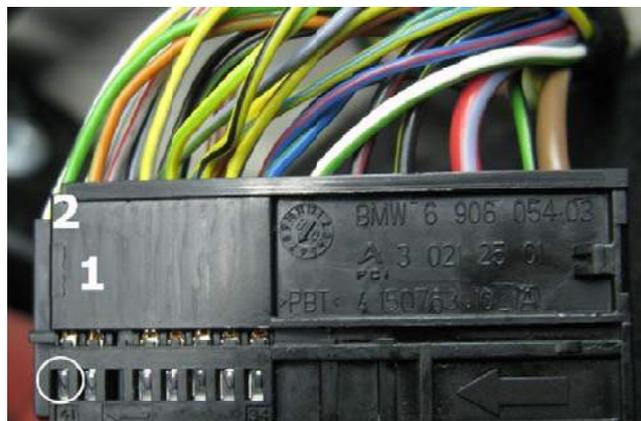
8. Stecken Sie die Pins in den losen Stecker vom Modul Kabelbaum. Grün auf Position 1 und orange/grün auf Position 2. Stecken Sie den Stecker nun auf sein Gegenstück im Modul Kabelbaum.
