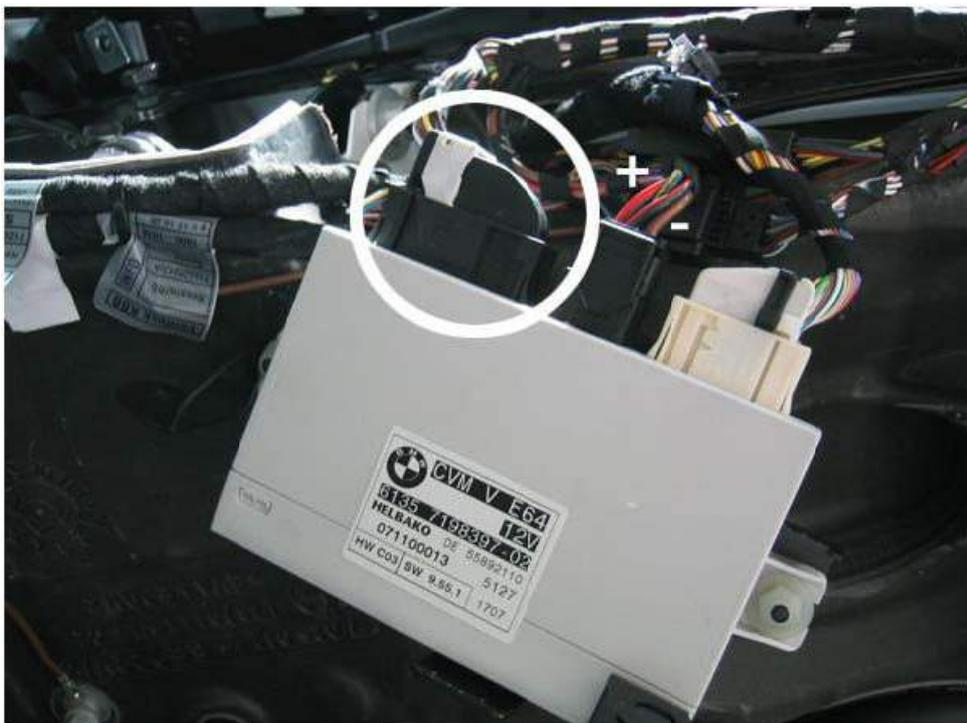
7. Ziehen Sie die Kappe vom Stecker ab. Heben Sie dafür die markierte Verriegelung an.
