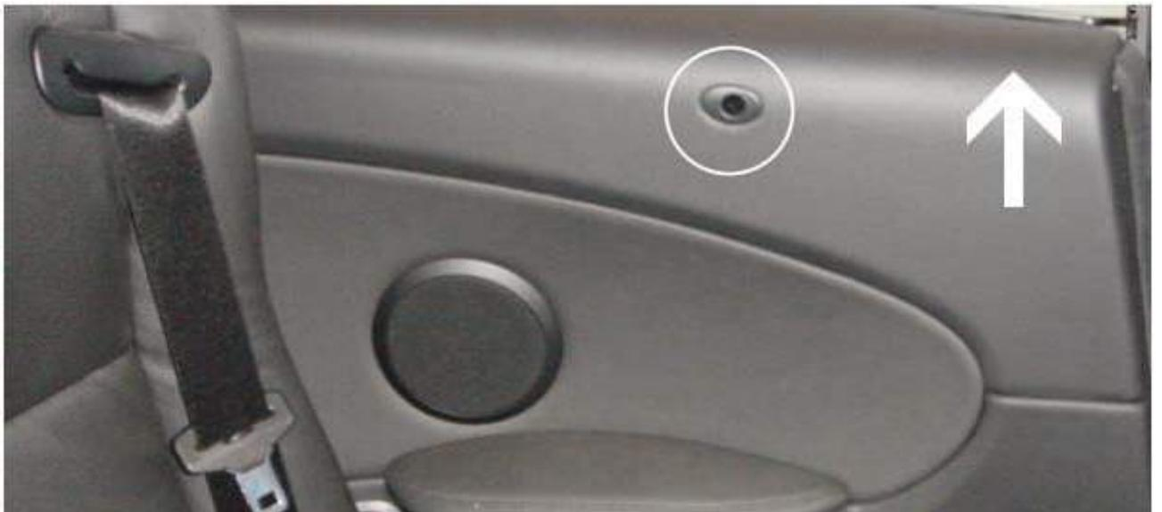
5. Entfernen Sie die markierten Schrauben, um das Verdeck Steuergerät zu entnehmen.
