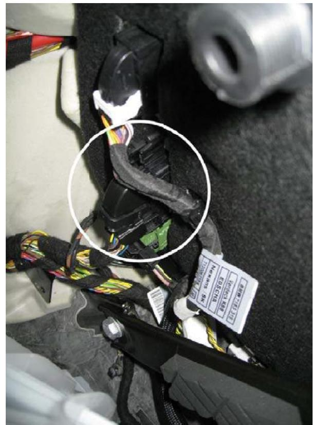
6. Ziehen Sie die Kappe vom Stecker ab. Heben Sie dafür die markierte Verriegelung an.
