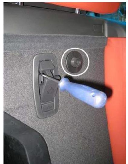
2. Entfernen Sie die den Dichtungsstreifen (1) und die Klappe vom Skisack (2). Anschließend hebeln Sie vorsichtig die Abdeckkappen ab und lösen die Schrauben darunter (3), (2x 10mm 6-Kant-Schrauben).
