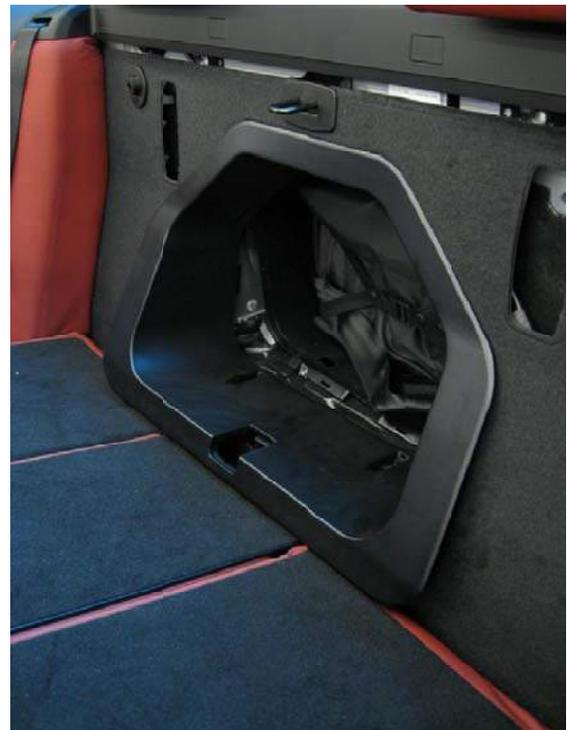
4. Lösen Sie das Seitenteil auf der rechten Seite. Dahinter befindet sich eine Verriegelung die Sie unter Umständen mit einem Schraubendreher öffnen müssen, damit sich das Teil leichter lösen lässt. Lösen Sie die Nieten unten am Teppich.
