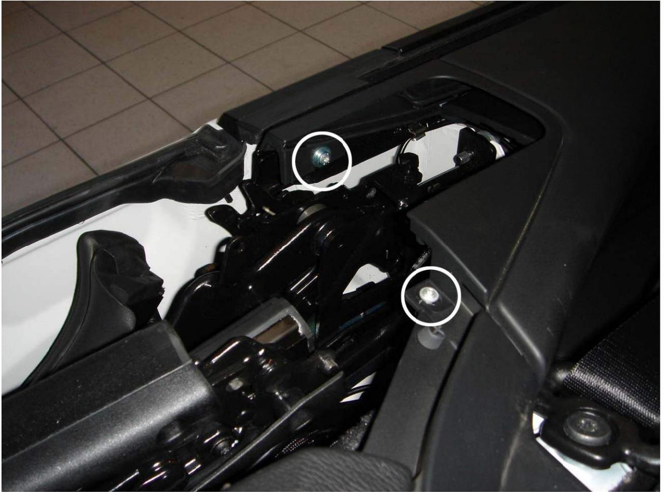
4. Lösen Sie die Schraube in der Windschotthalterung. Nun können Sie das Seitenteil von vorne anfangend nach oben abheben.
