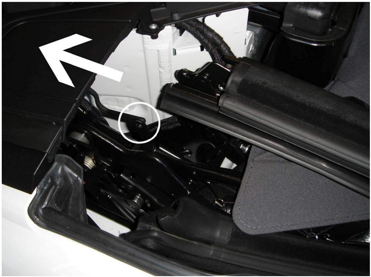
3. Lösen Sie die beiden Torx Schrauben.
