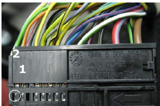
9. Stecken Sie die Pins in den losen Stecker vom Modul Kabelbaum. Schwarz auf Position 1 und gelb auf Position 2. Stecken Sie den Stecker nun auf sein Gegenstück im Modul-Kabelbaum.
