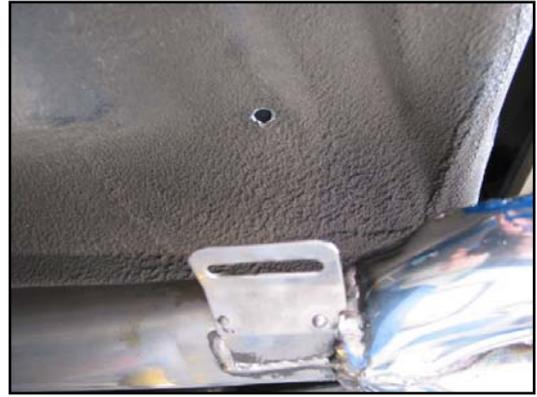
9. Vibrationsdämpfergummi mit dem Karosserieboden verschrauben und das Auslegerendrohr durch Verwendung der Unterlegscheiben in der richtigen Höhe fixieren. Schrauben nur leicht anziehen.
