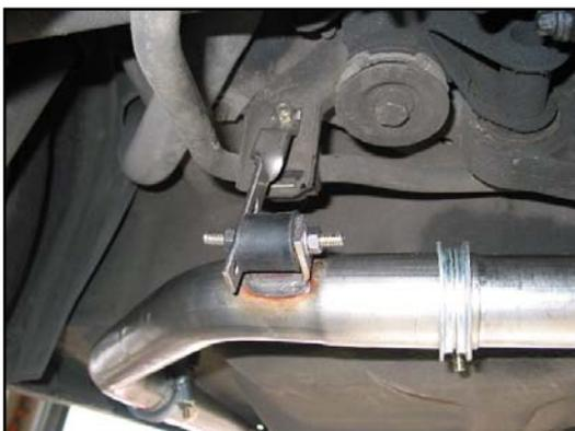
8. Auslegerendrohr auf den kleinen Rohrbogen aufstecken und im Heckschürzenausschnitt exakt ausrichten. Die Klemmschelle leicht festziehen und die Bohrung für den Vibrationsdämpfergummi im Karosserieboden anbringen.
