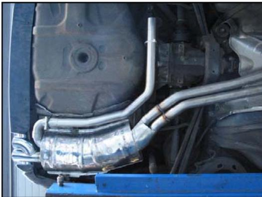
7. Den mitgelieferten Halter am rechten Stabilisatorenhalter befestigen. Den kurzen Bogen auf den grossen Rohrbogen stecken, Schelle leicht anziehen. Den Vibrationsdämpfergummi wie auf dem Bild dargestellt anbringen und Muttern nur leicht anziehen.
