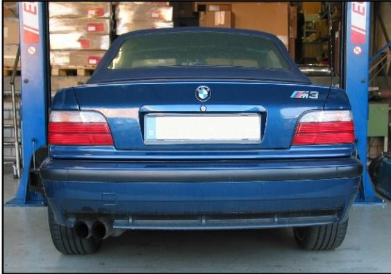
2. Den Original - Endschalldämpfer ausbauen. Diesen dazu mit geeigneten Vorrichtung abstützen und zuerst die Schrauben am Flansch und dann die beiden Halter am Schalldämpfer lösen. Falls Schrauben und Muttern schwer zu lösen sind, diese mit Rostlöser einsprühen.
