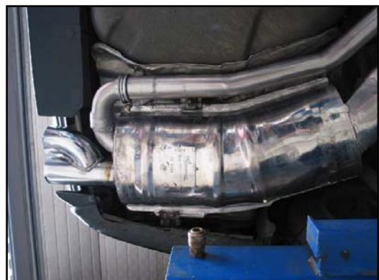
11. Ist die Anlage ausgerichtet, muss/müssen das/die Anschlussrohr/e mit dem Endschalldämpfer verschweisst werden. Dazu das/die Anschlussrohr/e mit mehreren Schweisspunkten am Endschalldämpfer abheften, die komplette Anlage abbauen (Ausleger kann am Fahrzeug verbleiben) und die Anschlussrohre verschweissen.
