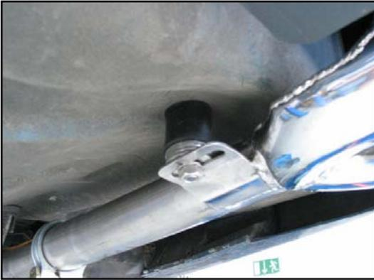
10. Die Auslegerendrohre und die Endrohre des **eisenmann®** - Endschalldämpfer im Heckschürzenausschnitt exakt ausrichten (die Position des Endschalldämpfers kann durch Verschieben der Original – Halter verändert werden).
