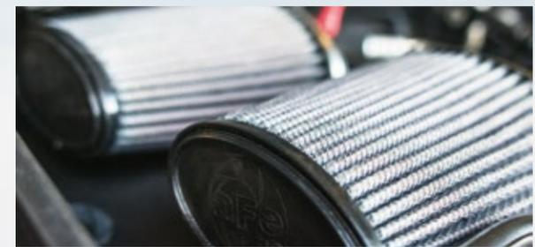
Direkt hinter der BMW-Niere saugt das mit zwei offenen Filtern bestückte AFE Einlass-System Frischluft an.
