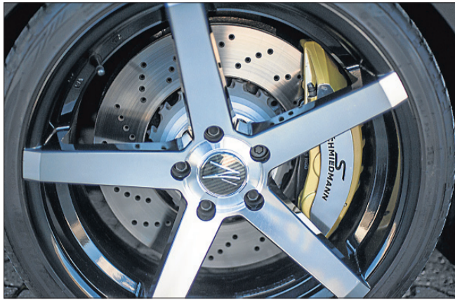
De enorme bremseskiver og kalibre af egen fabrikation ses tydeligt bag egerne i 20 tommer fælgen.
