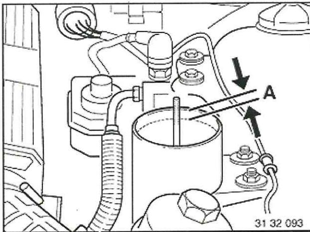
2. Auffüllen und Entlüften bei laufendem Motor.
