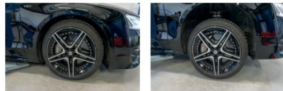
Lockern Sie die Radschrauben, mit Hilfe eines Radkreuzes oder Drehmomentschlüssels. **ACHTUNG! Nur lockern nicht heraus-schrauben!**
