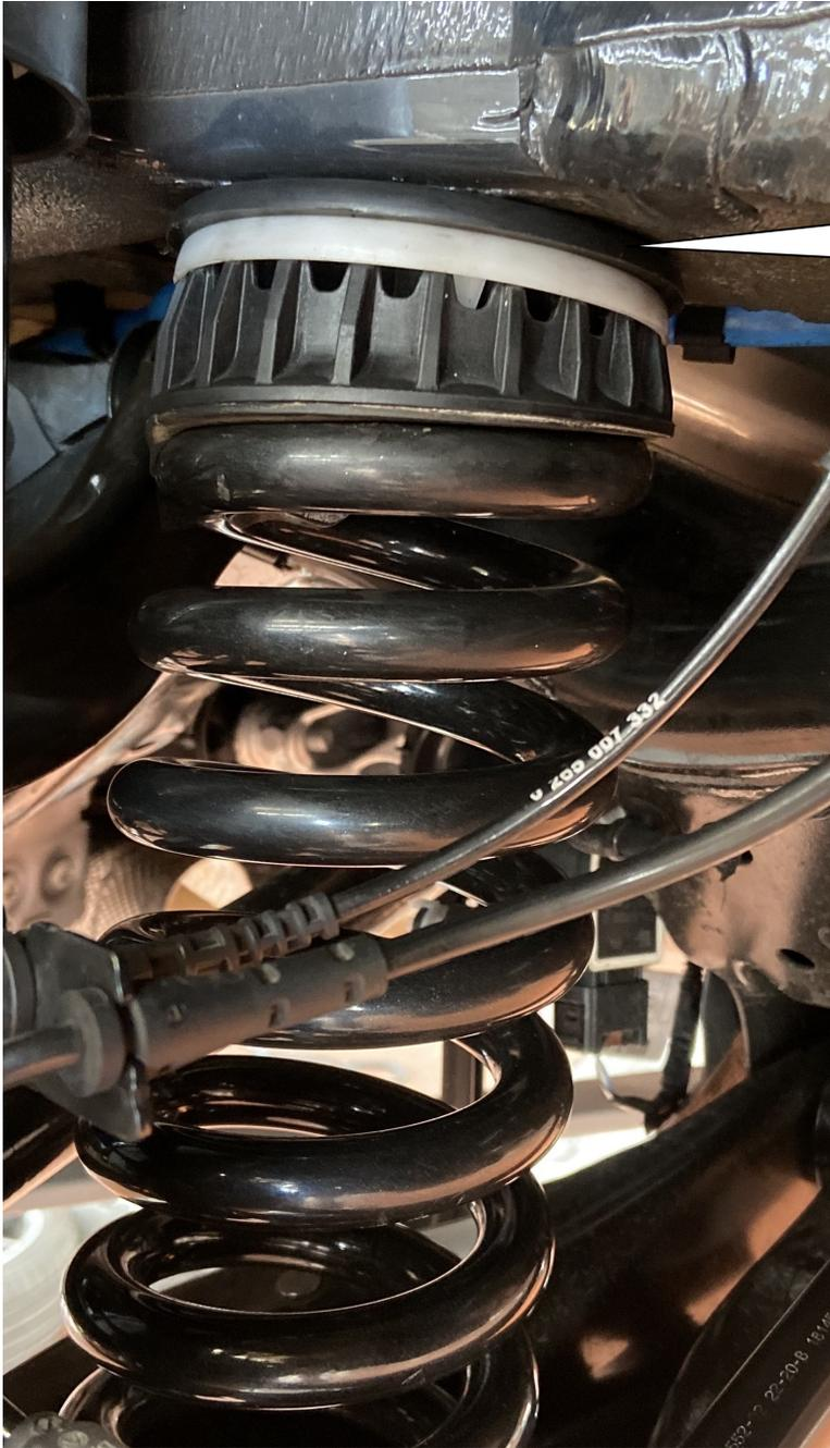
Die Gummiunterlage wird oben montiert.
